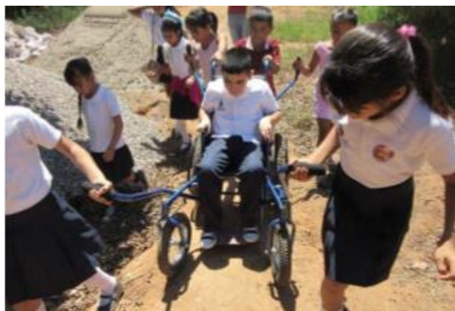
上面的照片展示的是全地形適用的蜘蛛車輪椅，是在墨西哥鄉下能跨過困難地形，帶孩童上學使用。這種設計能使其他的孩童一起幫助移動輪椅。照片是由 HealthWrights 允許使用。
